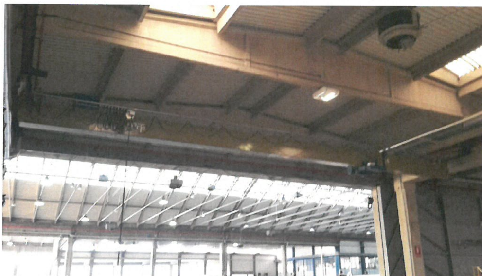
Foto 27 – Carroponte ex-Assemblaggio
